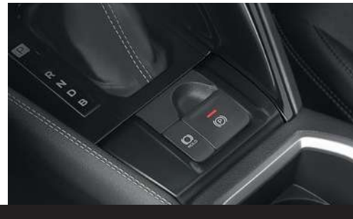
Freno de mano electrónico (EPB) con función "Auto-Hold"
