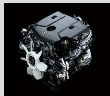
Motor 2.8l de 204 CV de potencia máxima
