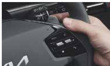
Caja Doble Embrague de 6 marchas c/ levas al volante
