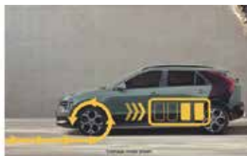
Batería de Litio de 1,32 kWh c/ Frenado Regenerativo
